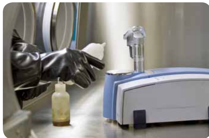
Рисунок 6. Спектрометр ALPHA внутри перчаточного бокса
